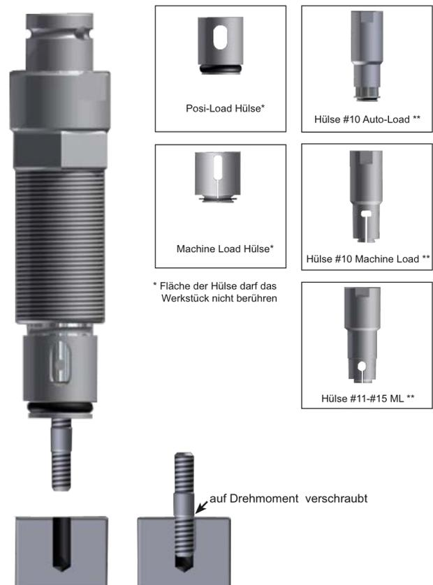
\*\* Zum Führen einer längeren Stiftschraube bei Drehmomentverschraubungen. Die Fläche der Hülse darf hier das Werkstück nicht berühren.
